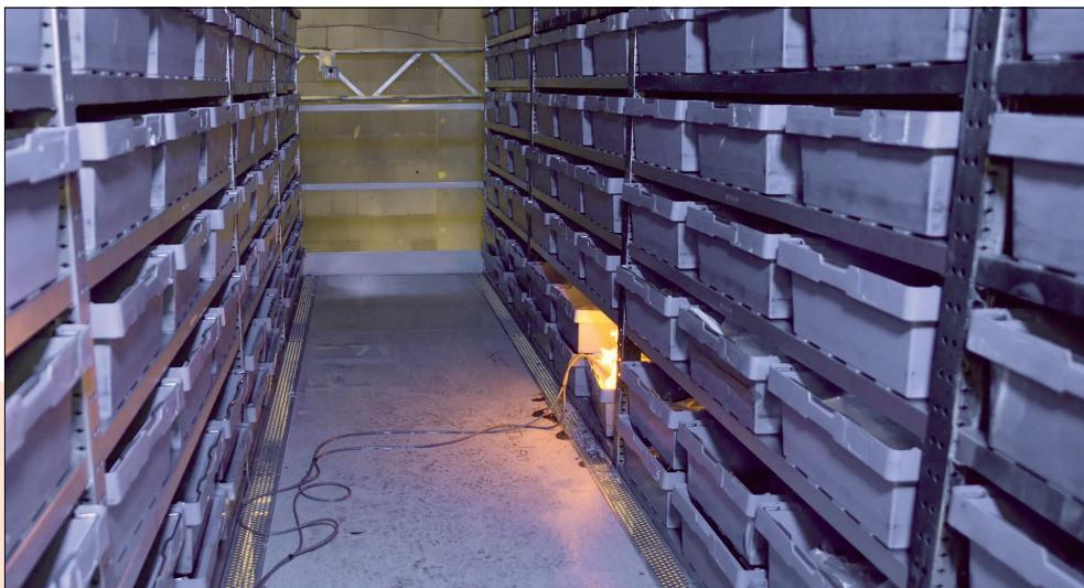
Bei diesem Brandversuch wird ein Lageraufbau im untersten Fach entzündet (Foto: Fire Protection Solutions)
