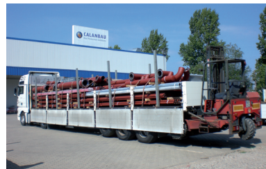
Abb.: Offener Auflieger und Mitnahmestapler
