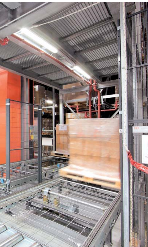
Warenausgang mit integriertem vollautomatischem Etikettierer sowie Vertikalumsetzer für zwei Paletten, die zusammen aufgenommen und nach links und rechts abgegeben werden
