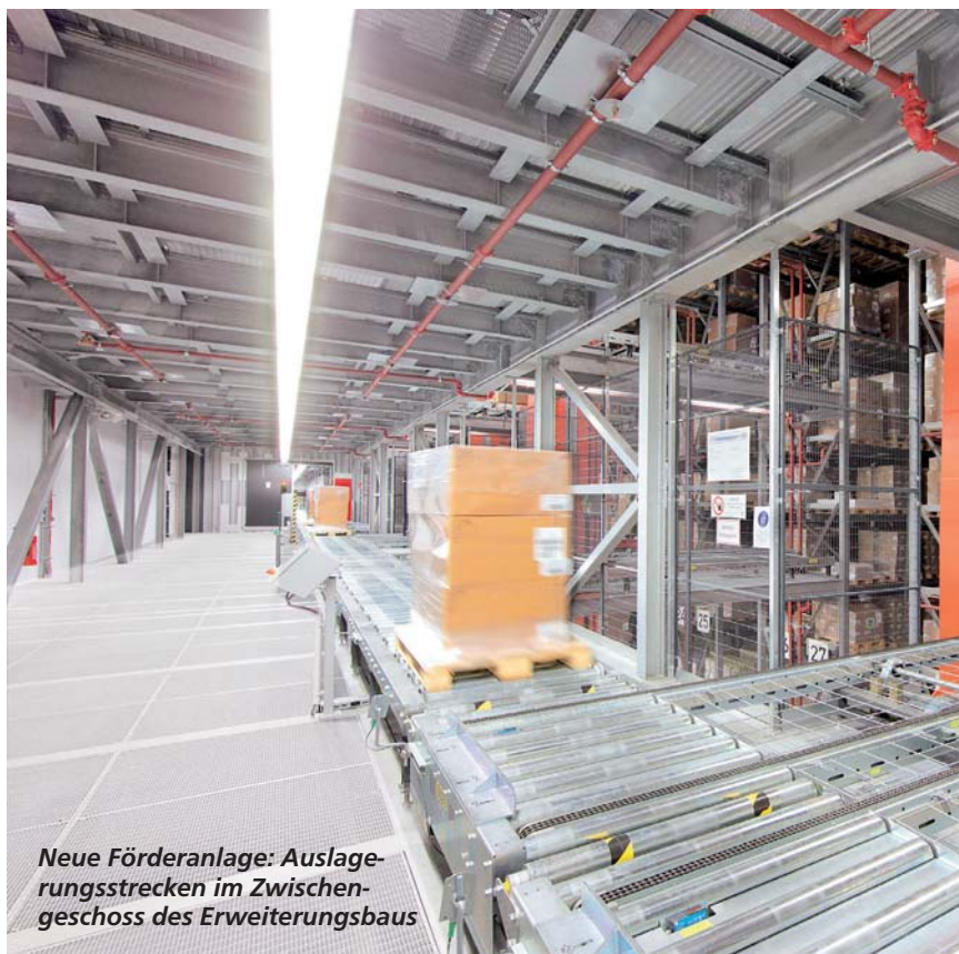
Durch die Erweiterung des Distributionslagers um acht Gassen wurden fast 40000 neue Palettenstellplätze geschaffen. Je Gasse wird ein RBG vom Typ MSingle eingesetzt
